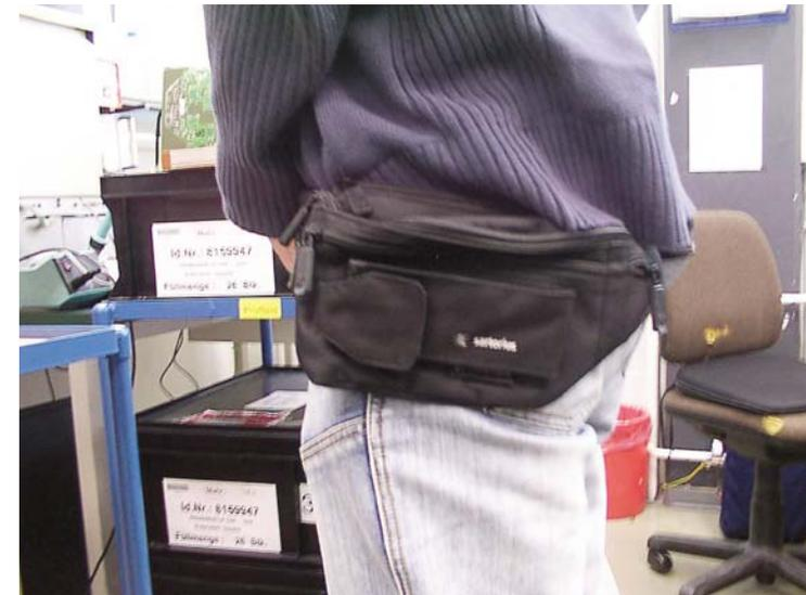
*Abb. 5: Bisher an verschiedenen Stellen liegendes Werkzeug trägt nun jeder Mitarbeiter in einer Werkzeuggestasche am Mann*
